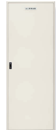
出入管理装置 [板金製] WFC-16 [16ゲート(扉)] 600 (W)×1,600 (H)×200 (D) UPSを内蔵することにより 約30分間の停電補償。 (UPS2台必要)
